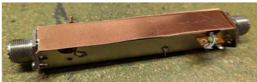
Ilustracja 26: Zdemontowany sprzęgacz kierunkowy z dodatkowym ekranowaniem
