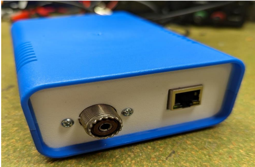
Ilustracja 29: Panel przedni i panel tylny został wyprodukowany przy użyciu druku 3D
