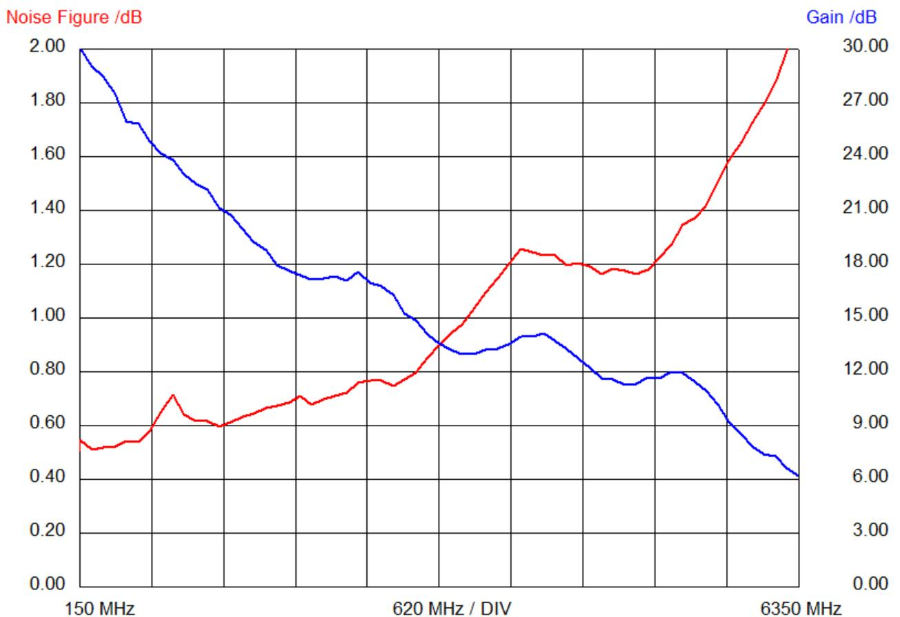
Der Verstärker kann im Bereich 145 bis 3400 MHz sehr gut verwendet werden, wobei die Verstärkung über diesem Frequenzbereich von 30 dB auf 13 dB abfällt und gleichzeitig die Rauschzahl von 0,5 dB auf 1,0 dB ansteigt.
