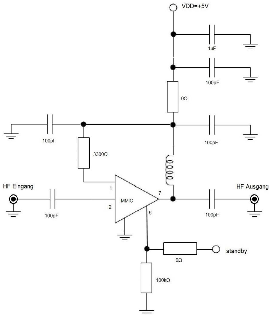
Der MMIC QPL9547 ist mit einer typischen Rauschzahl von 0,3 dB und einer Verstärkung von 19,4 dB (bei 1,9 GHz) spezifiziert. Zu beachten ist aber, dass bei dieser Rauschzahl die Verluste insbesondere der Platine herausgerechnet sind. Interessant ist auch sein durchaus gutes Großsignalverhalten was sich mit einem Output P1dB von +22,8 dBm (fast 200 mW) und einem OIP3 von +39,2 dBm manifestiert.
