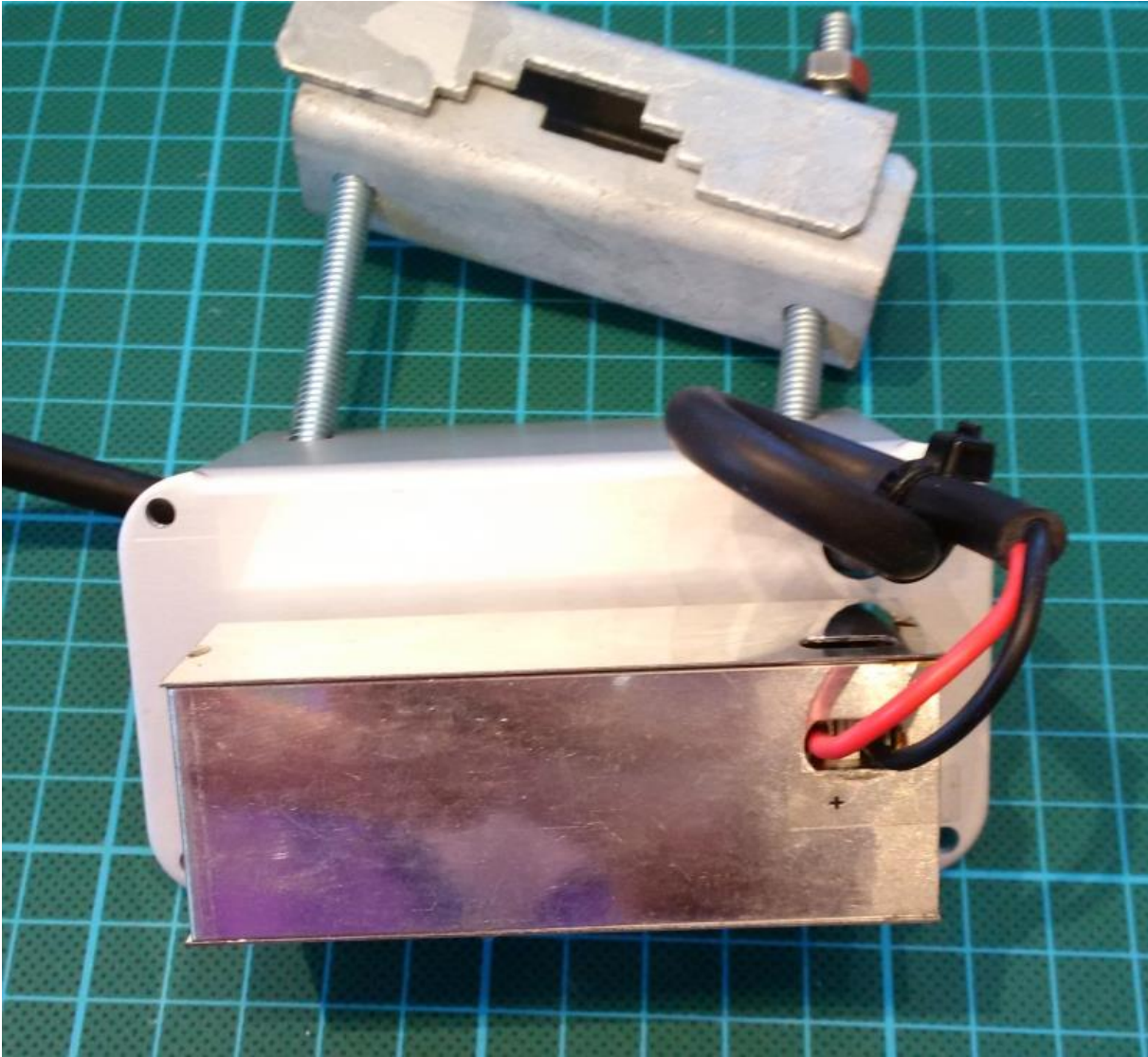
Mittels eines 2 poligen Klemmstegs wird das Kabel mit dem 12V Schaltsignal angeschlossen.
