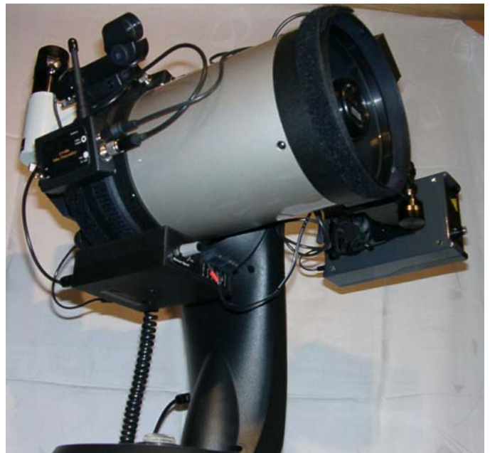
NexStar5 mit Steuerempfänger für die elektrische Fokussierung unter dem OTA, Laserpointer rechts, Videosender links am OTA
