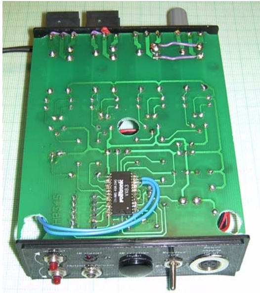
Unterseite des geöffneten Infrarot-Steuerempfängers Sicht von vorne, im Vordergrund der Dekoder - IC
