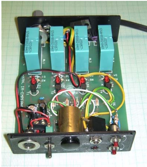
Oberseite des geöffneten Infrarot-Steuerempfängers Sicht von vorne, im Vordergrund der IR-Vorverstärker
