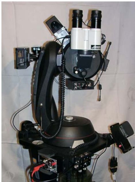
NexStar5 mit diversem Zubehör: Binokular, Laserpointer, Telradsucher, elektrischer Fokussierung, Taukappenheizung
