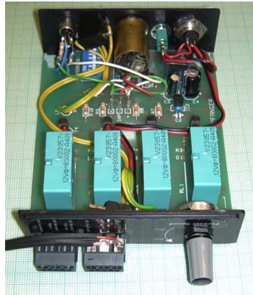
Oberseite des geöffneten Infrarot-Steuerempfängers Sicht von hinten, Im Vordergrund die 4 Relais
