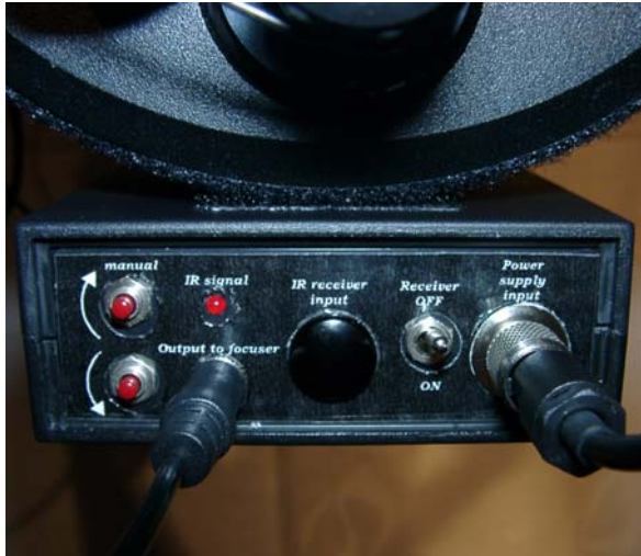
Frontseite des Infrarot-Steuerempfängers (v.r.n.l. Stromversorgungsbuchse, Einschalter, IR-Detektor, Buchse für Motor, Kontroll-Leuchtdiode, manuelle Aktivierung des Motors)
