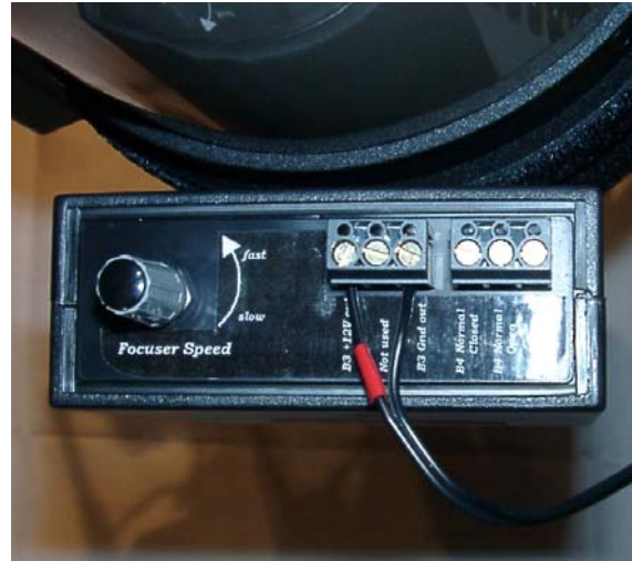
Rückseite des Infrarot-Steuerempfängers (rechts 2 potentialfreie Schaltausgänge mit jeweils Öffner und Schließer, links Drehregler für Geschwindigkeit des Fokussiermotors)
