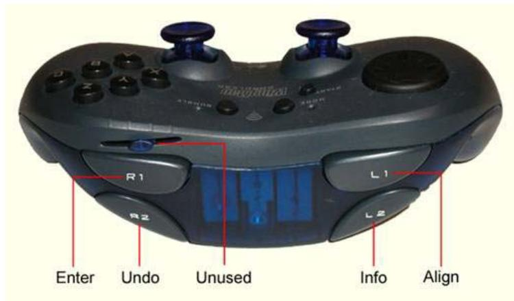
Der rechte Steuerknüppel steuert die Bewegung des Teleskops entsprechend den Richtungstasten auf dem Handsteuerepult. Die sechs Tasten auf die Oberseite des Wingman erlauben Ihnen, die gewünschte Bewegungsgeschwindigkeit des Teleskops auszuwählen als auch um zwischen den vier Menüpunkten umzuschalten: Menü (MENU), Liste interessanter Objekte (OBJECT LIST), Liste der Planeten (PLANET LIST) und Auswahl einer Tour (TAKE A TOUR).
