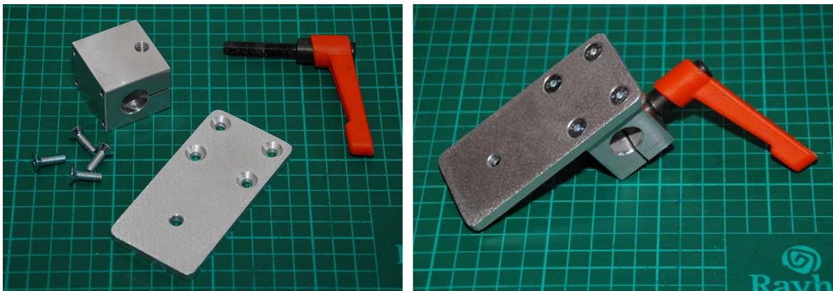
Dieser Adapter wird auf die Gegengewichtsstange des Telementors geschoben und festgeklemmt. Darauf wird dann der leicht modifizierte Kamerakopf geschraubt.
