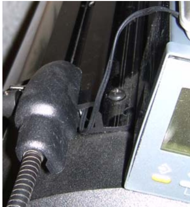
Kabel wird durch die hohle Schiene geführt
