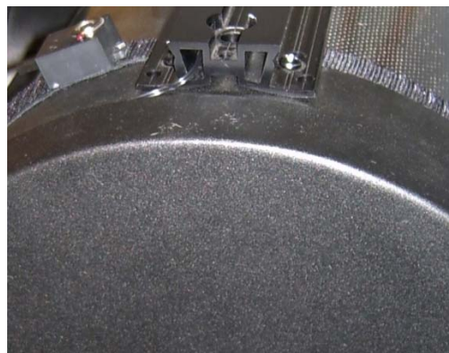
Abdeckkappe des Tubus aufgesetzt, Kabel stört nicht
