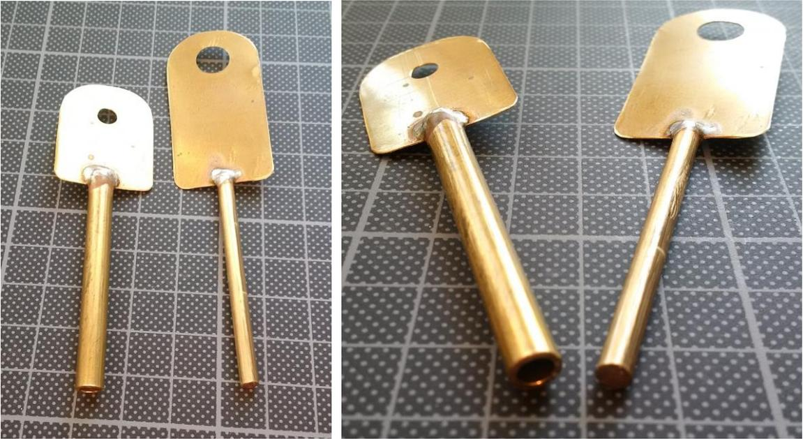
Die 0.3mm dicken Messingbleche sind mit dem Messinggrundstab und dem Messingrohr verlötet. Zuvor wurden in den Stab und das Rohr kleine Schlitz eingesägt.
