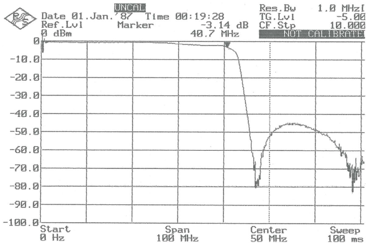
Die Einfügedämpfung ist im Bereich DC bis 30 MHz unter 1dB, die Welligkeit sehr gering. Die 3dB Grenzfrequenz des Tiefpassfilters liegt bei 40 MHz. Das Filter ist sehr steil und bereits bei ca. 47 dB wird eine Sperrdämpfung von ca. 70-80dB erreicht. Danach fällt die Sperrdämpfung im Bereich von 50-60 MHz auf ca. 45dB ab. Im Bereich bis ca. 1 GHz bleibt sie danach über 60dB wie das nächste Bild zeigt.
