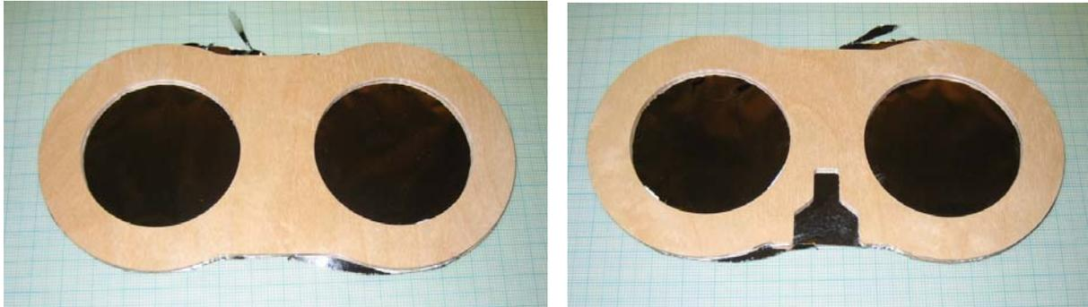
Dann wird das dritte Teil direkt auf das mittlere Teil geklebt. Außerdem muss der Alusteg, welcher in die Aussparung der „Sonnenbrille“ gesteckt wird noch abgewinkelt werden.
