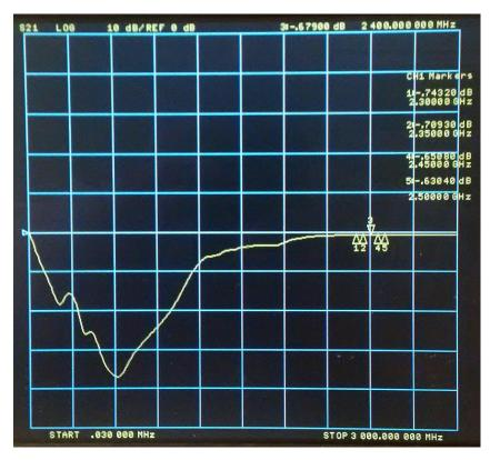
S12 reverse isolation (isolation 36.7dB@2300MHz, 36.8dB@2359MHz, 37.0dB@2400MHz, 37.1dB@2450MHz, 37.3dB@2500MHz)
