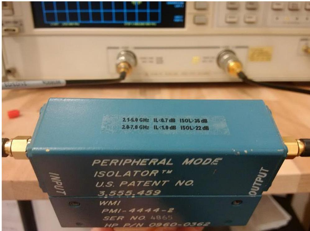
S11 Input return loss (28.9dB@2300MHz, 30.1dB@2350MHz, 30.5dB@2400MHz, 30.0dB@2450MHz, 29.1dB@2500MHz)
