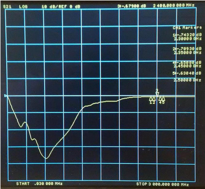
S12 reverse isolation (isolation 36.7dB@2300MHz, 36.8dB@2359MHz, 37.0dB@2400MHz, 37.1dB@2450MHz, 37.3dB@2500MHz)
