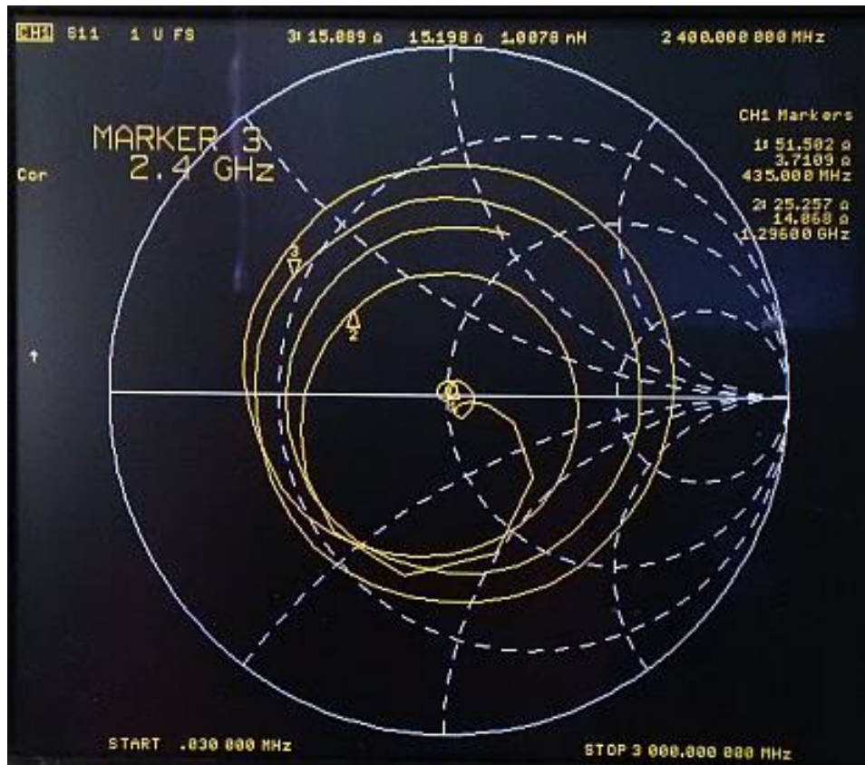
S11 Eingangsimpedanz in einem Smith-Diagramm dargestellt
