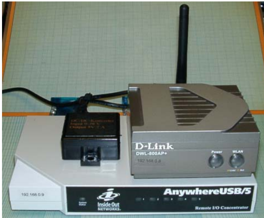
Komplettes Setup mit AP, I/O-Concentrator und Stromversorgung
