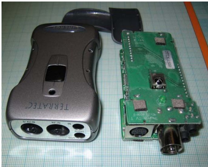
1) Terratec Cinergy 250 USB, links Gehäuse, rechts Innenleben
