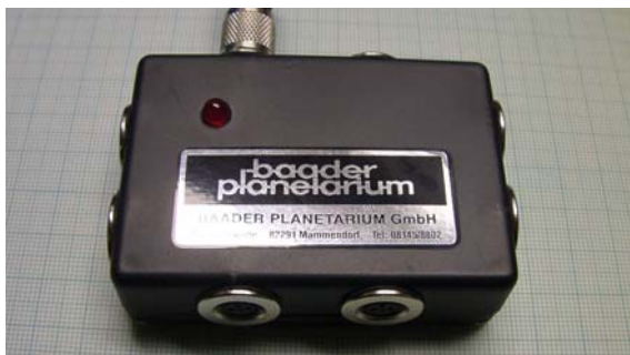
Verteilerblock mit roter LED für Kontrollanzeige der Heizung (blinkt schwach im Takt der Heizung)
