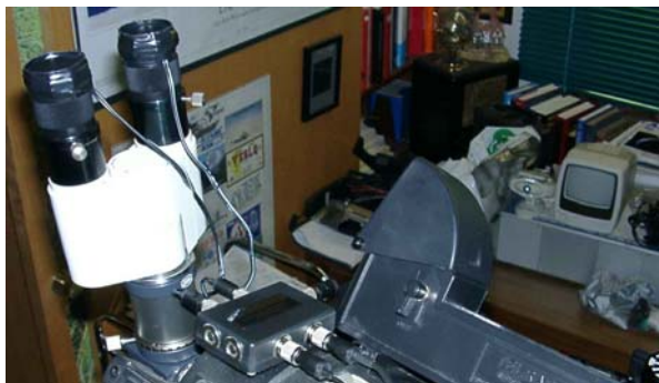
NexStar5 von oben mit Verdrahtung des Telrad-suchers und der beiden Okulare
