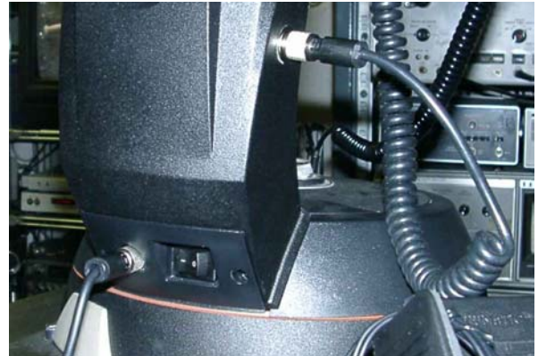
NexStar5 umgebaut für neuen Stromversorgungsstecker, links unten der Eingang, rechts an der Halterung ist ein Ausgang für die weitere Verdrahtung
