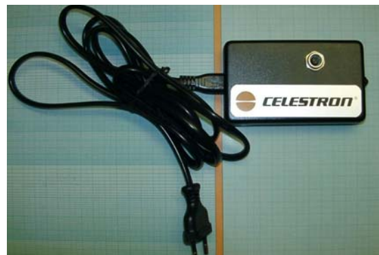
12V Schaltnetzteil zur Versorgung des NexStar5
