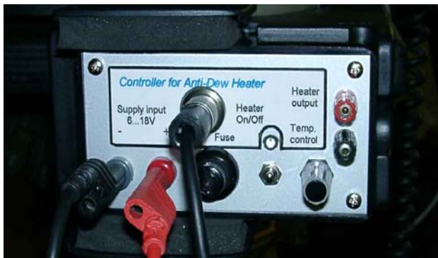
Frontansicht des Taukappenheizung-Steuergerätes
