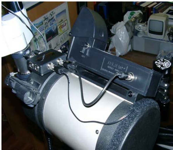
NexStar5 von oben mit Verdrahtung des Telrad-suchers und der Heizmanschette der Korrektorlinse
