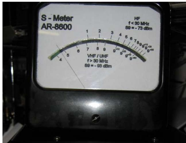
Übrigens zeigt die Anzeige in meinem Fall bei allen eingestellten Demodulationsarten den gleichen S-Wert (bei einem unmodulierten Träger) an. Nur wenn ich WFM (Breitband-FM) als Demodulator einstelle ist die Anzeige nicht mehr identisch. Da ich den WFM Modus ja aber nur für den Empfang von Rundfunksendungen im UKW Bereich nutze, ist dies für mich kein größeres Problem. Es würde mich interessieren, ob dieser Effekt auch bei anderen Nutzern gleichartig auftritt.
