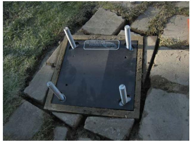
Rechts ist ein Foto der Bodenplatte aus massivem Aluminium inklusive einigen Bemessungen zu sehen. Die Platte stammt wie die höhenverstellbare Säule selbst von der Firma Pier-Tech. Dank der großen Langlöcher, in welchen die Gewindestäbe verschraubt werden, kann eine Feinjustage der Nordrichtung erfolgen. Nord ist in dem Bild rechts entweder oben oder unten. Das Pier selbst wird mittig aufgesetzt und mittels der 4 Stück 3/8“ Schrauben (siehe grüne Bemessung) befestigt.
