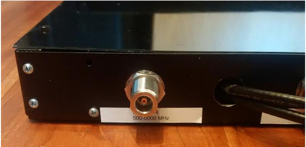
Die Antenneneingangssignale werden an 4 N-Buchsen in den Verteiler gespeist.
