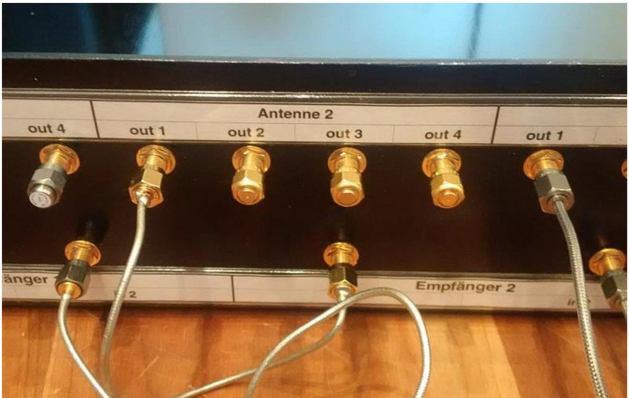
Verbindung der Antennenausgänge zu den Empfängereingängen durch kurze Patchkabel.
