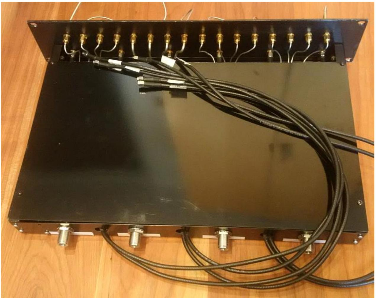
Die Empfängereingänge werden mittels der schwarzen, doppelt geschirmten Koaxialkabel des Typs RG-223 mit dem Antennenverteilstück verbunden.
