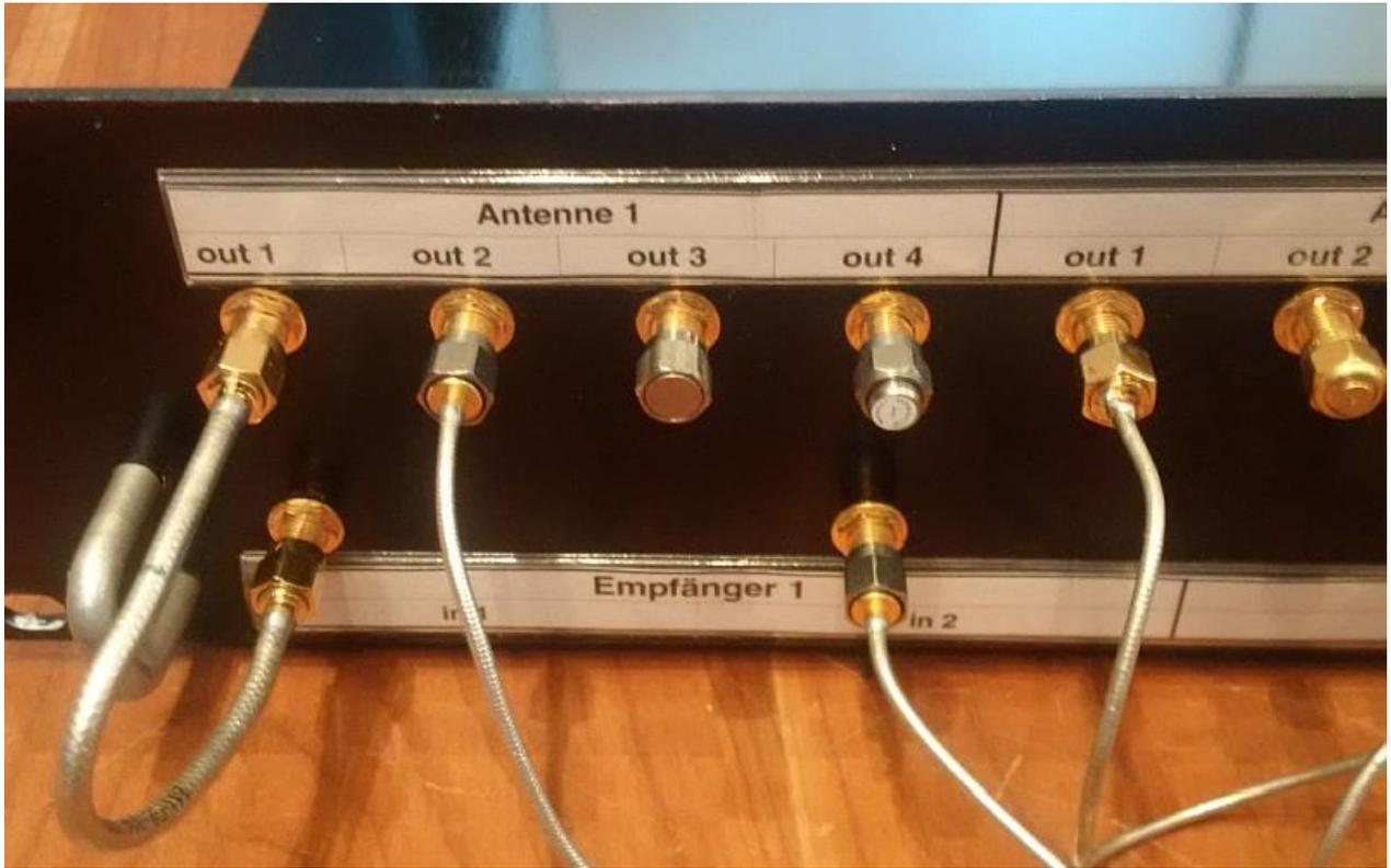
An der Frontplatte liegt jedes Antennensignal parallel an 4 Ausgängen auf. Die nicht verwendeten Ausgänge sind mit 50 Ohm Abschlüssen terminiert um die Daten der Power-Splitter sicher zu stellen. Jeder Empfänger hat 2 Antenneneingänge.
