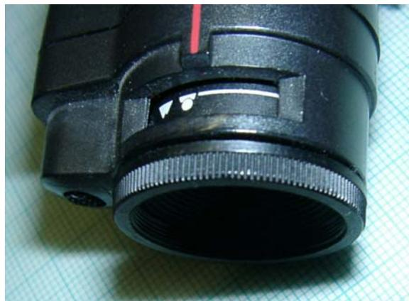
Der Kamerakopf hat vorne ein Objektiv, mit welchem man manuell scharf stellt. Innen hat das Objektiv ein Innengewinde auf welches adaptiert werden soll.
