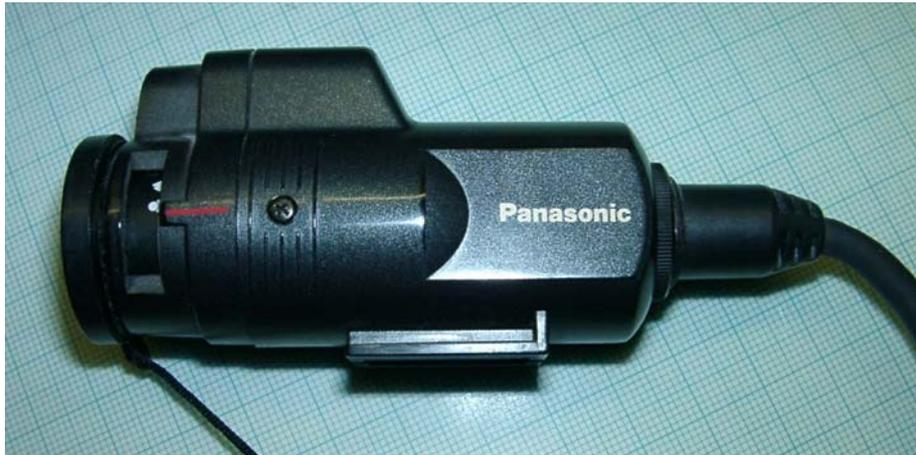
Der Kopf ist mit einem ca. 60cm langen Kabel (rechts zu sehen) mit dem Grundgerät verbunden. Dieser Kopf soll mit dem OPFA verbunden werden.
